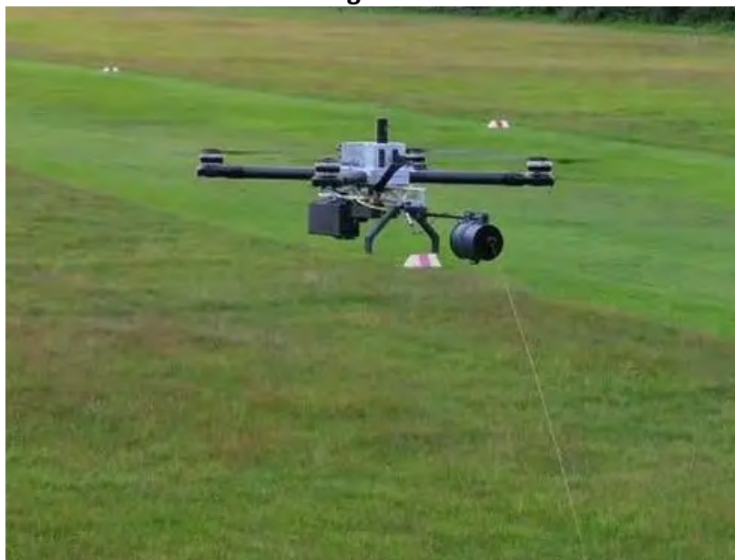
Mini-drone « Prince Vandal » à caméra thermique et guidage par fibre optique
